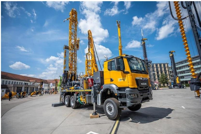
(1) Die RB 65 Bohranlage der neuesten Generation verfügt über eine elektrische Vorsteuerung, Automatisierungsprozesse machen den Einsatz noch wirtschaftlicher und sicherer.
