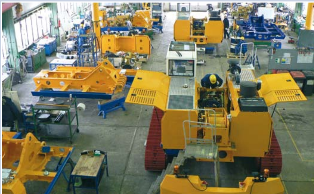
Монтаж поворотной платформы с кабиной
